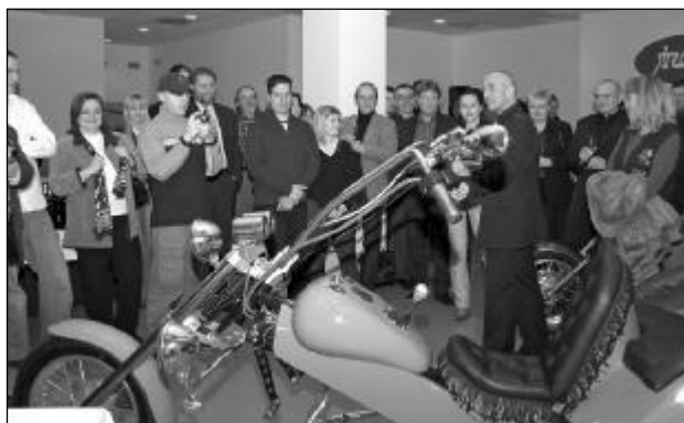
Streamer je vybaven motorem Škoda 1,3 MPI. Váží 760 kilogramů a dokáže jet až 130 kilometrovou rychlostí při průměrné spotřebě 6 litrů. V nově otevřeném pražském showroomu ji představil motorkář Standa Berkovec.
