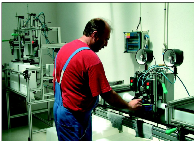
Zaměstnanci společnosti si sami sestavují některé technicky náročné automatické linky. Automat, který na snímku obsluhuje Jiří Hladík, je schopen svařovat, tlakovat, ale i ořezávat nádržky předstěnového systému.
